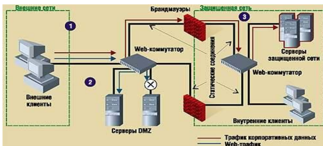
Рис. 1 - Использование брандмауэров для защиты сети
