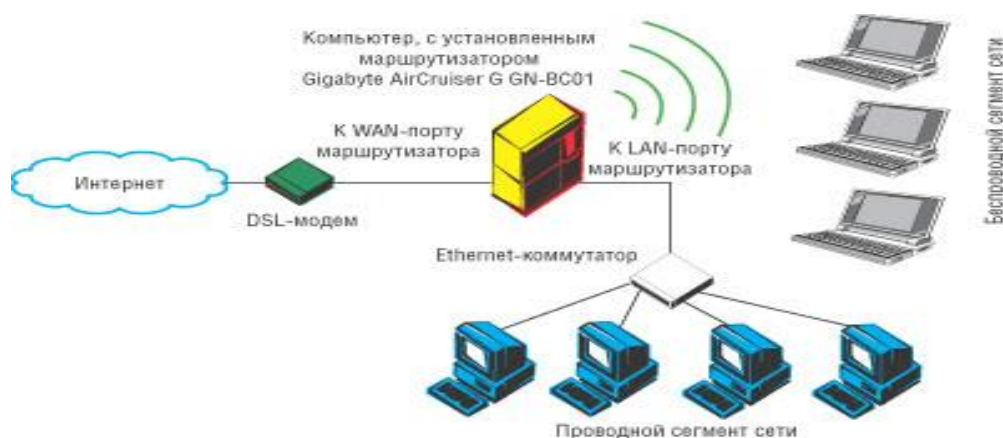
Рис. 2 - Использование маршрутизатора и модема в сети
