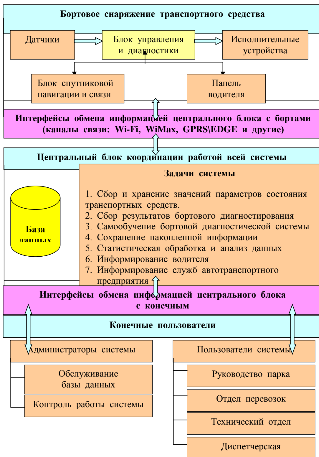
Рис. 2. Структурная схема информационной системы оперативной оценки технического состояния автотранспортных средств.
