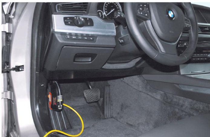
Рисунок 8.1 – Під'єднати до діагностичної системи за допомогою одного роз'єму (ICOM A)
