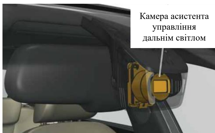
Рисунок 6.4 – Розміщення камери системи управління дальнім світлом
