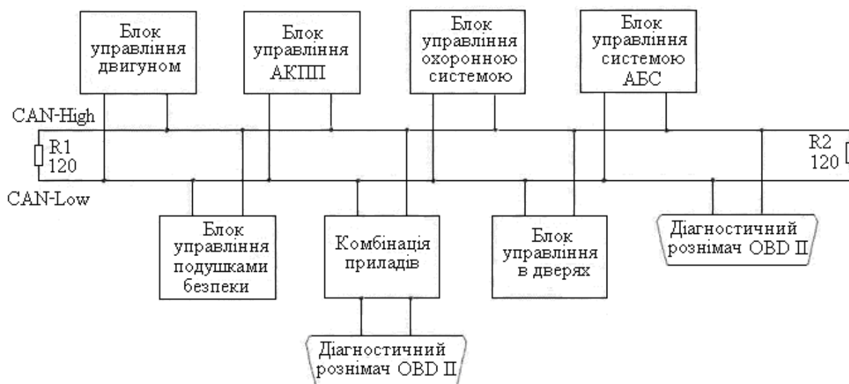
Рисунок 3.2 – Типова схема шини CAN
