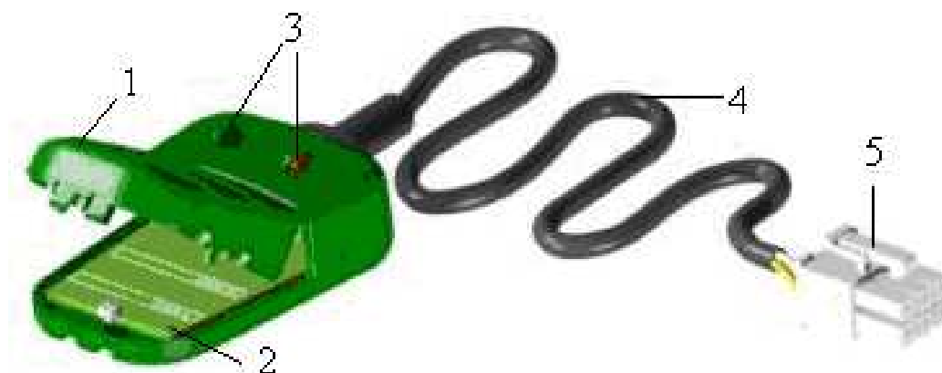
Рисунок 3.8 – Безконтактний пристрій CANCrocodile
