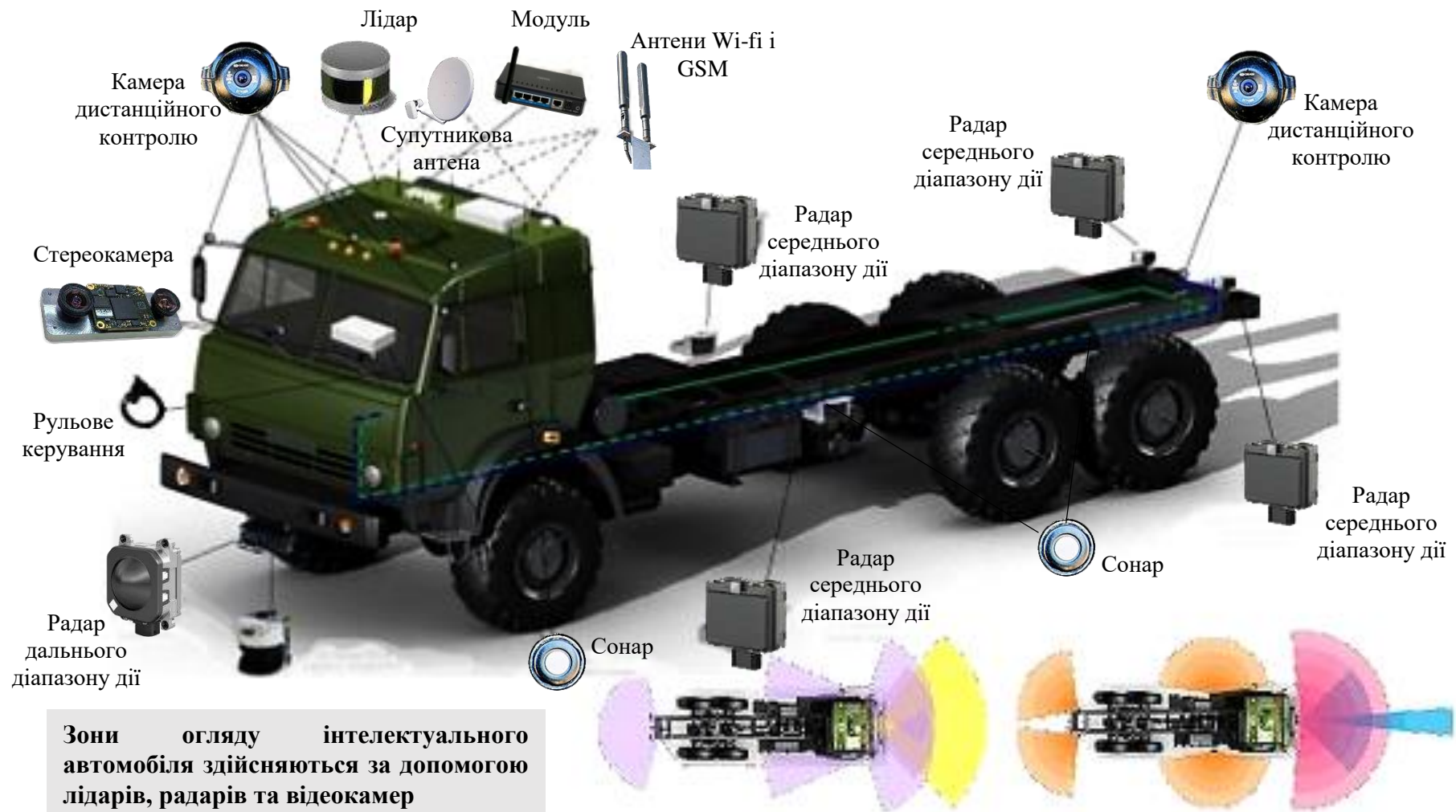
Рисунок 1.7 – Компоненти систем керування рухом інтелектуального автомобіля
