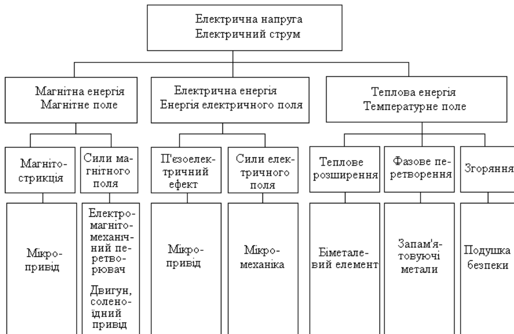
Рис. 2.2. Електромеханічні виконавчі механізми (система)
