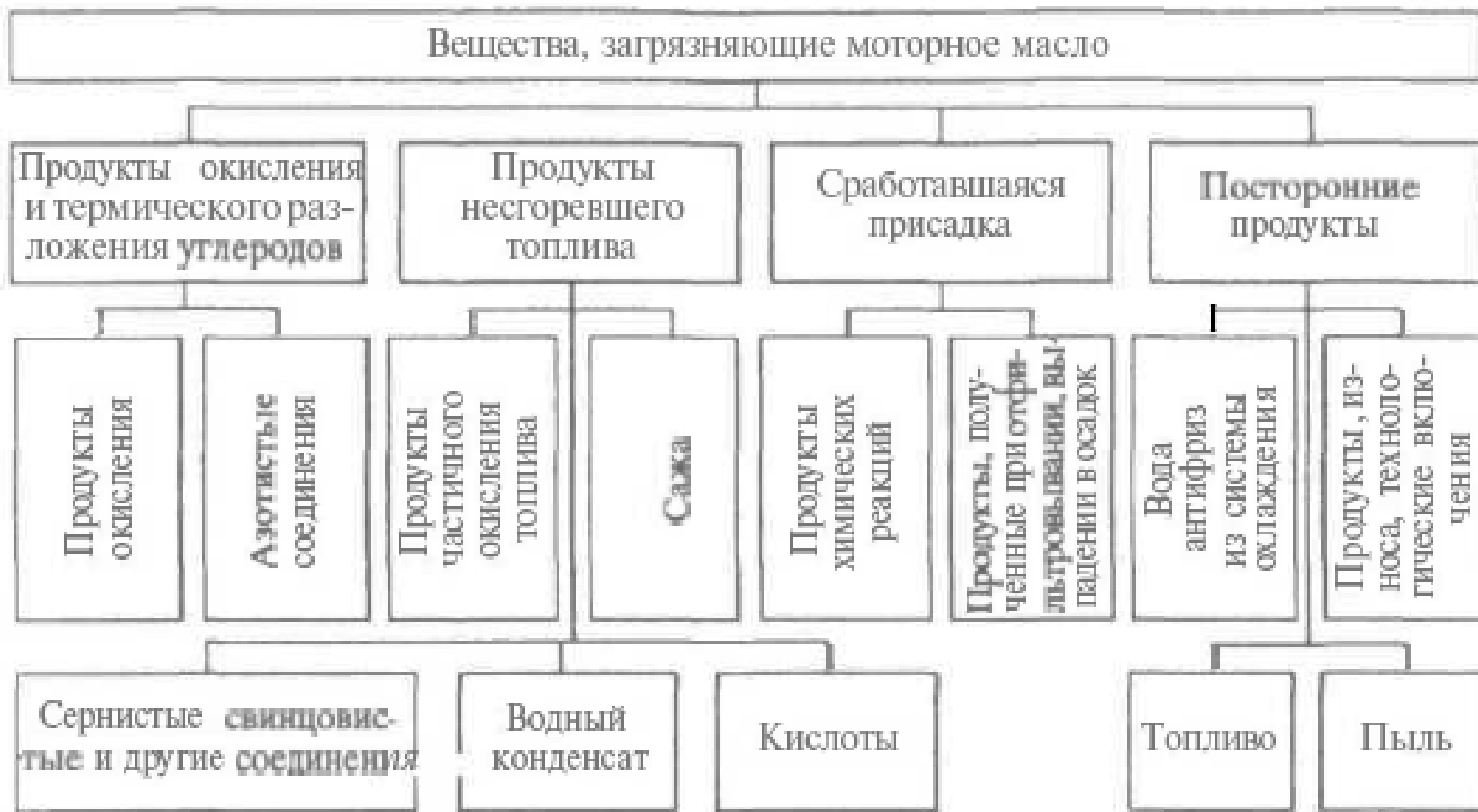
Схема процесса старения моторного масла
