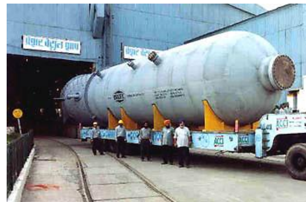
130-ти тонный реактор гидроочистки дизельного топлива, изготовленный фирмой ISGEC для завода Indian Oil в Гуджарате.
