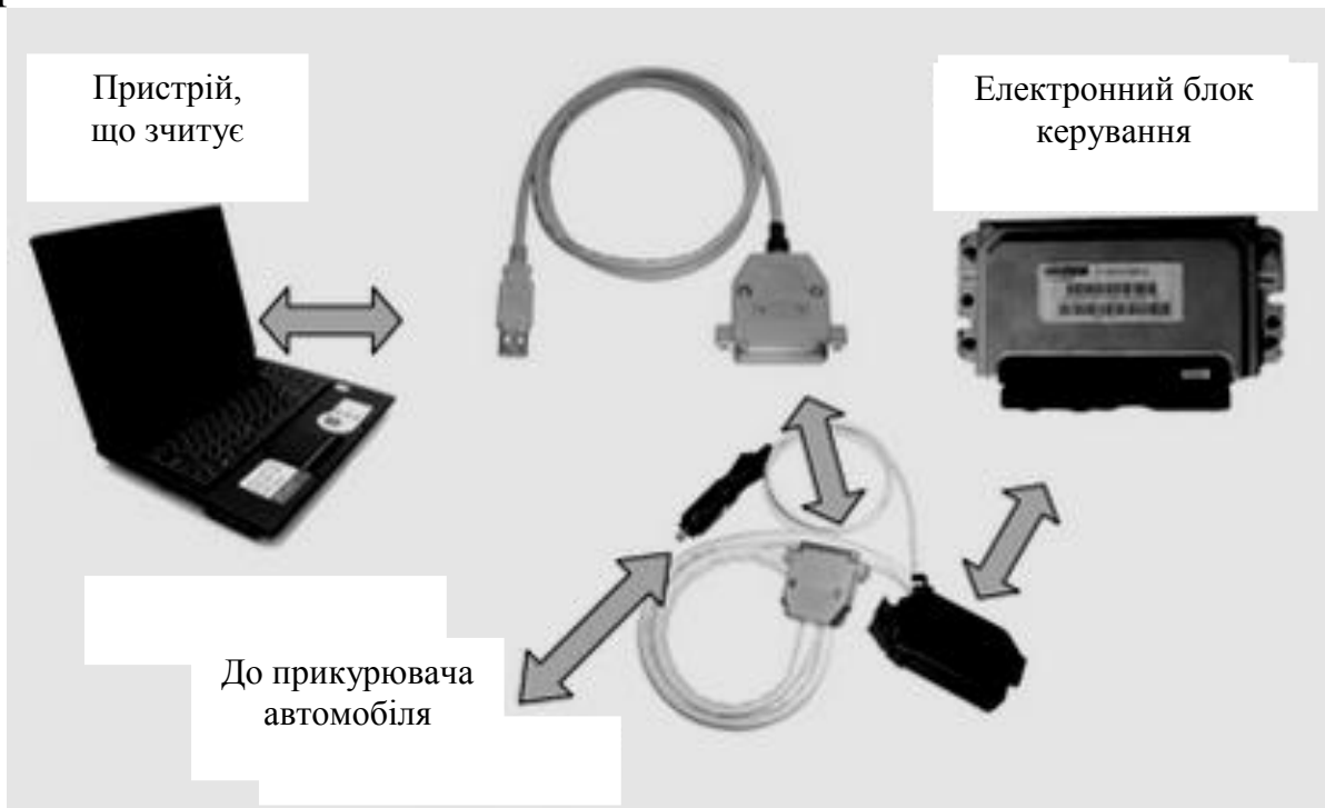
Рис. 1.2. Схема підключення USB KL-Line адаптера до блоку керування автомобіля
