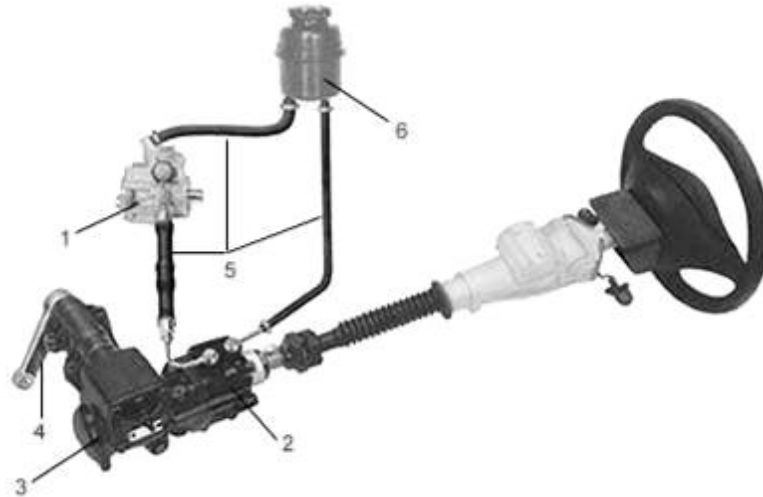
Рис.56.2. Гідропідсилювач з гідроциліндром в рульовому механізмі: 1 – насос, 2 – корпус розподільника, 3 – рульовий механізм, 4 – рульова сошка; 5 – сполучні шланги; 6 – бачок
