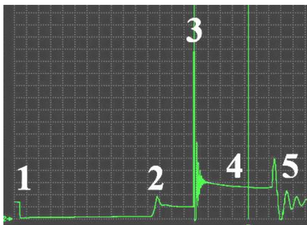
Рис. 16.9. Осциллограма напруги в первинному ланцюзі безконтактної СЗ: 1 - мить відкриття силового транзистора комутатора (початок нагромадження енергії в магнітному полі котушки запалювання); 2 - мить переходу комутатора в режим обмеження струму в первинному ланцюзі (по досягненні струму в первинній обмотці котушки запалювання рівного близько 8А, комутатор переходить у режим обмеження струму на цьому рівні); 3 - мить закриття силового транзистора комутатора (пробій іскрового проміжку між електродами свічі запалювання і початок горіння іскри); 4 - ділянка горіння іскри; 5 - кінець горіння іскри й початок загасаючих коливань
