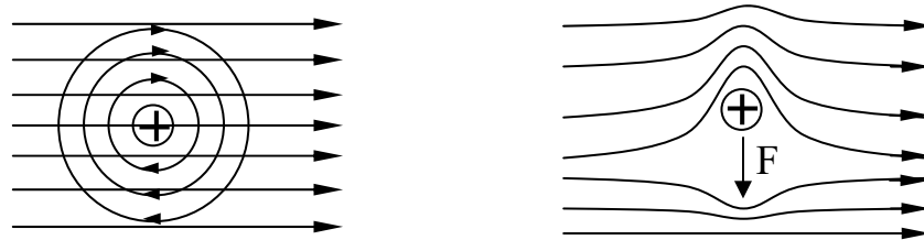
Рис. 15. Провідник із струмом у магнітному полі: а – поля навколо провідника; б – результуюче поле
